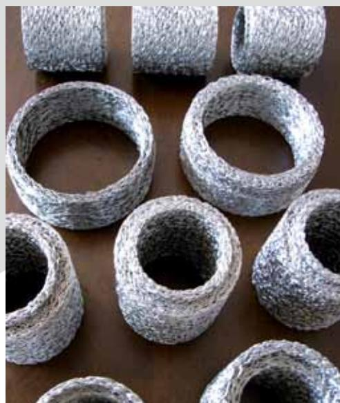
ニットメッシュで製作されるデミスターは、空間率94%~99%と極めて大きいために、通過するミストの圧力損失を小さくすることができます。また、表面積を大きく取れるために、重量が軽く線表面の大部分が気体と接触します。
