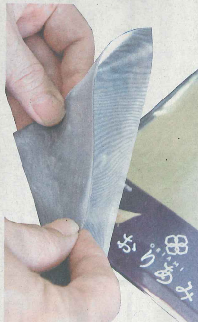
極細の金網でできたシートは紙と同じように指で簡単に折れる
