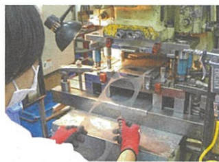
要望に合わせた金型を作り手作業でカット
