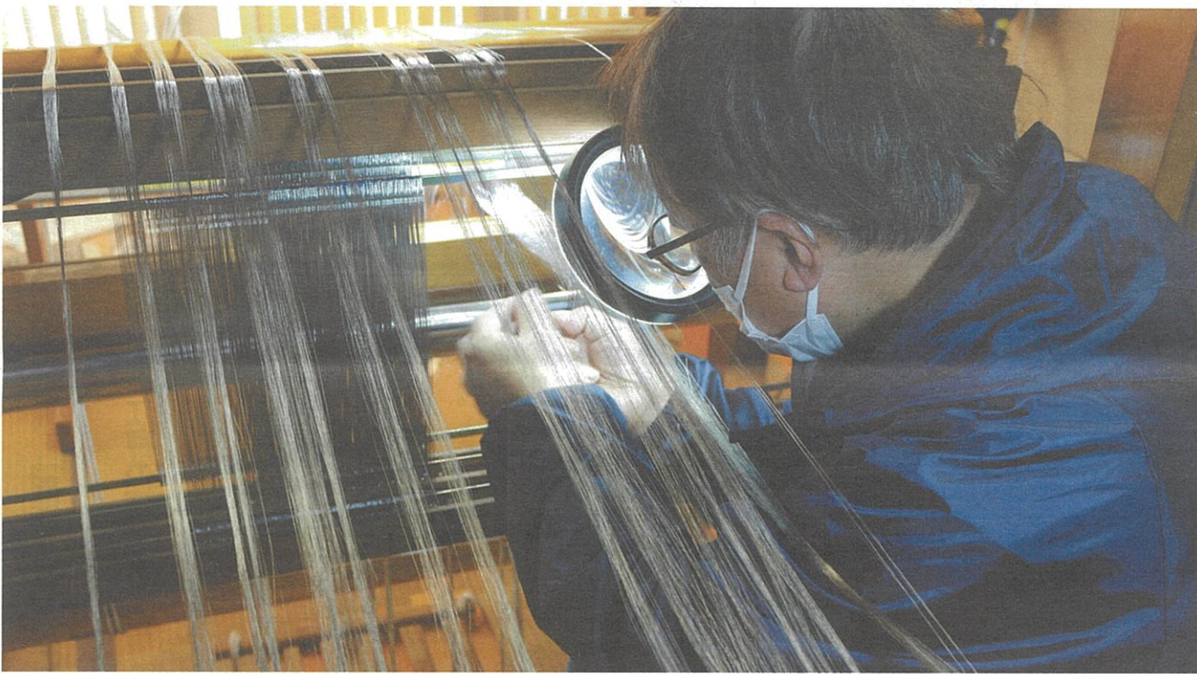
織物の手織り機を、金属が織れるように改良したものを現在も使用している。これが「ORIAMI」など新製品の発想の原点
